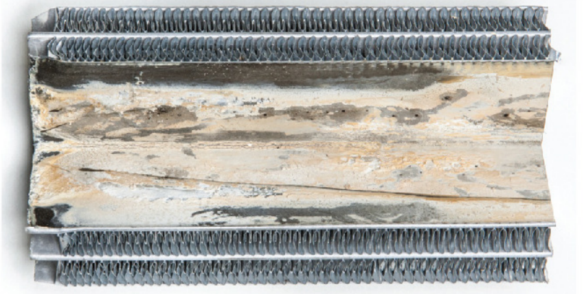
ภาพนี้แสดงให้เห็นว่าคราบตะกรันสามารถเกิดขึ้นภายในท่อของหม้อน้ำของท่านได้หากใช้น้ำยาหล่อเย็นที่ไม่มีคุณภาพ โดยที่คราบดังกล่าวเป็นสาเหตุให้น้ำยาหล่อเย็นไม่สามารถไหลผ่านหม้อน้ำเพื่อการระบายความร้อนที่ดีได้ แต่เมื่อเปลี่ยนมาใช้น้ำยาหล่อเย็น John Deere Coolant คราบเหล่านี้จะไม่เกิดขึ้น ทำให้ความสามารถในการระบายความร้อนเป็นไปได้อย่างดี
