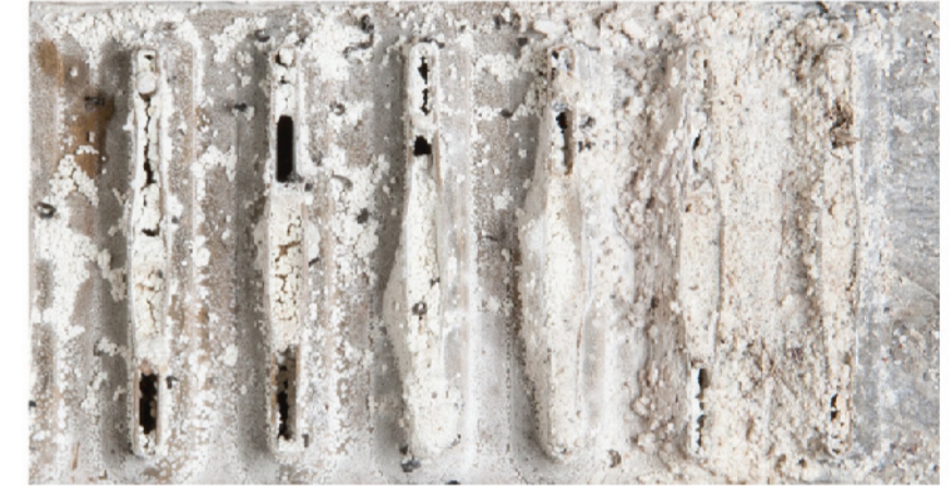
ภาพนี้แสดงให้เห็นว่าคราบตะกรันสามารถเกิดขึ้นภายในท่อของหม้อน้ำของท่านได้หากใช้น้ำยาหล่อเย็นที่ไม่มีคุณภาพ โดยที่คราบดังกล่าวเป็นสาเหตุให้น้ำยาหล่อเย็นไม่สามารถไหลผ่านหม้อน้ำเพื่อการระบายความร้อนที่ดีได้ แต่เมื่อเปลี่ยนมาใช้น้ำยาหล่อเย็น John Deere Coolant คราบเหล่านี้จะไม่เกิดขึ้น ทำให้ความสามารถในการระบายความร้อนเป็นไปได้อย่างดี
