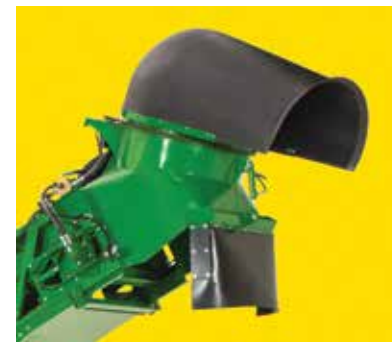
ชุดพืดลมเล็ก ช่วยให้การทำความสะอาดก่อนอ้อย และด้วยการหมุนฝาครอบได้ 360 องศา จึงสามารถพ่นเศษใบอ้อยไปในทิศทางที่ต้องการได้
