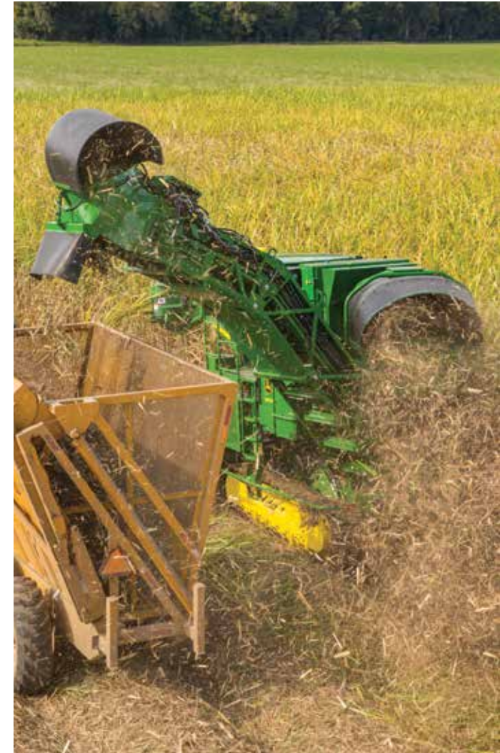
ชุดพืดลมเล็ก ช่วยให้การทำความสะอาดก่อนอ้อย และด้วยการหมุนฝาครอบได้ 360 องศา จึงสามารถพ่นเศษใบอ้อยไปในทิศทางที่ต้องการได้
