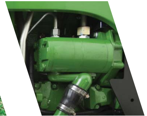
ปั๊มไฮดรอลิกแบบเฟืองคู่ อัตราการไหลสูง
