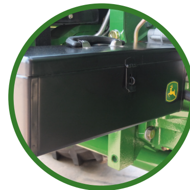
กล่องเก็บอุปกรณ์ภาคสนามใช้งานง่ายและเก็บอุปกรณ์ได้อย่างมิดชิดพร้อมห้วงคล้องเพื่อล็อกกุญแจได้อย่างปลอดภัย
