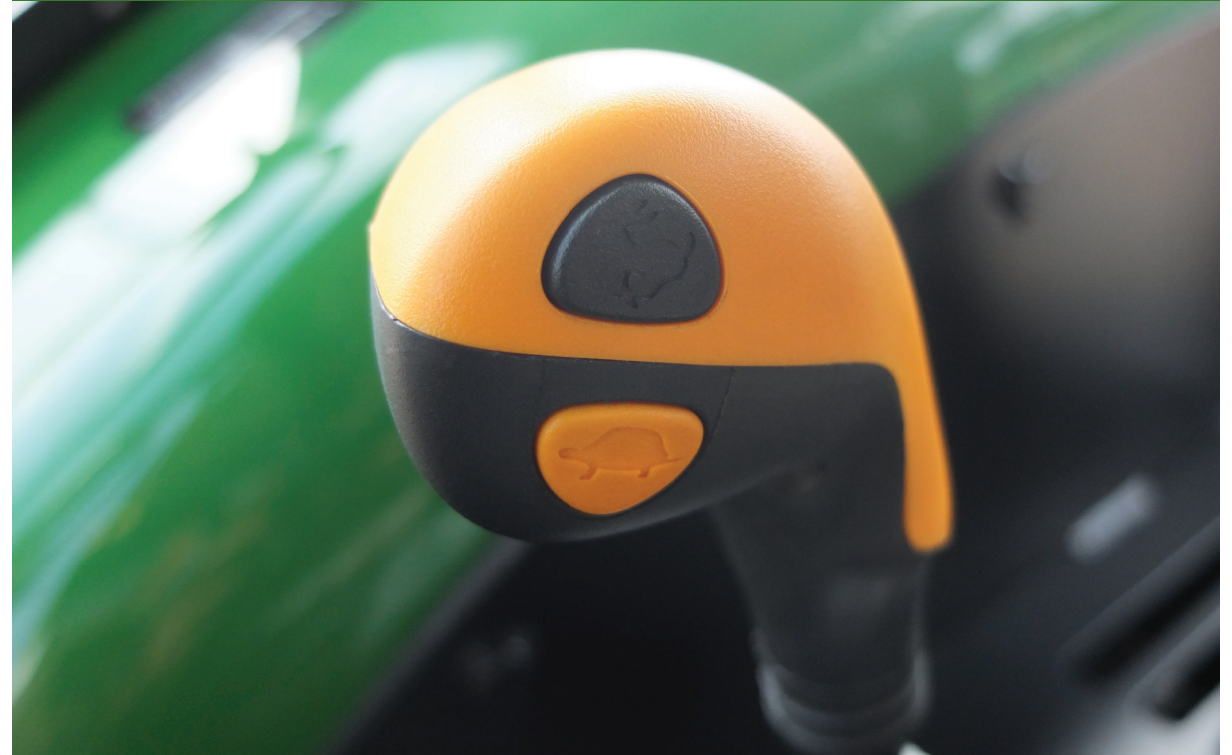
ระบบเกียร์ทือปซาร์ฟซิงโครไนซ์พลัสเด็นหน้า 12 จังหวะ ถอยหลัง 4 จังหวะ คลัทช์แห้ง
